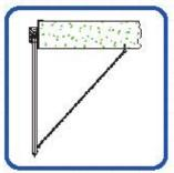
G. Dispositif de blocage en position ouverte
