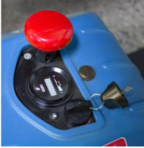
Indicateur de décharge de batterie, interrupteur à clé, sectionneur d'urgence.
